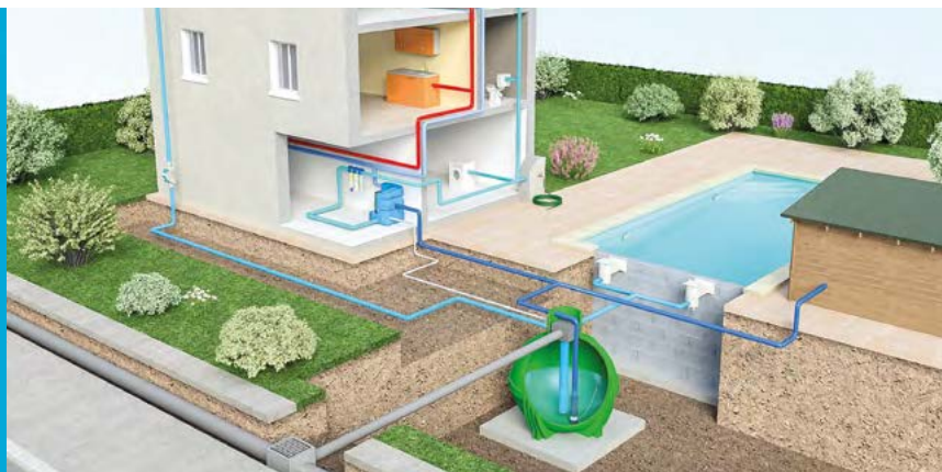
Mise en situation de la Globus (cuve de récupération d'eau de pluie) sur un terrain de maison individuelle.
